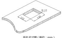
开孔尺寸图 (单位:mm)
